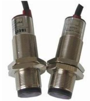
D、园柱型反射式光电开关：(作用同上) 共有 3 条线，其中 2 条电源输入，棕色：+12V、蓝色：GND 和 1 条信号输出，当人经过反射式光电开关时（反射距离为 10-20mm）输出+12V，反之为 0V。
